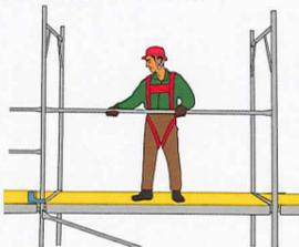
3 Garde-corps intérieur (constructions à ossature)
